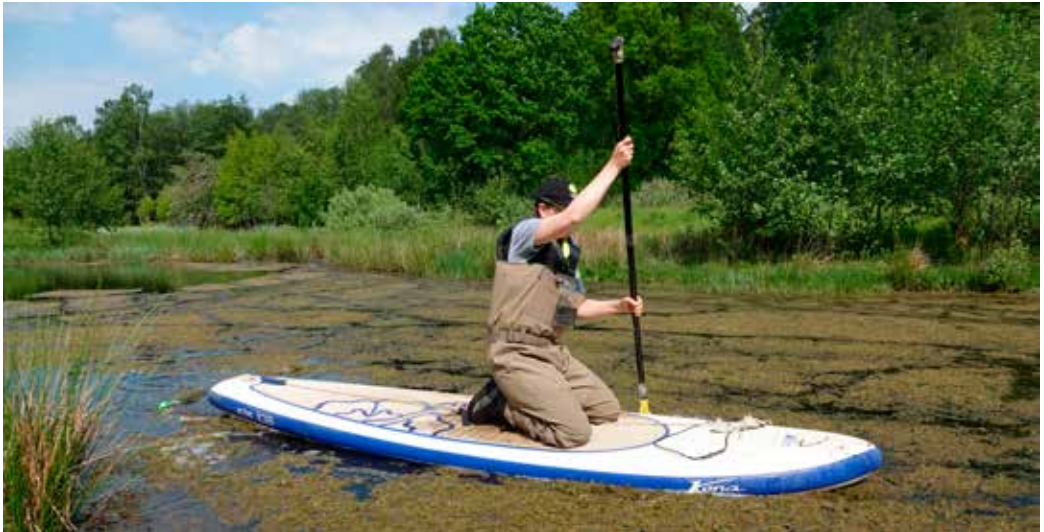
FIGUR 3. Här djupkarteras våtmarken med ett ekolod av typen "Deeper", det är den lilla gröna bollen som kan anas sitta i ett rep till vänster om paddelbrädan på bilden. FOTO: John Strand.
